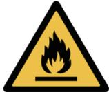
Le fluide frigorigène utilisé dans cet équipement est inflammable. L'exposition du fluide frigorigène à une source d'inflammation externe peut causer un risque d'incendie.
